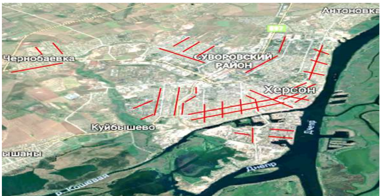
Умовні позначення: — мережа зливової каналізації Рис. 2 Схема зливової каналізації на території міста Херсон
